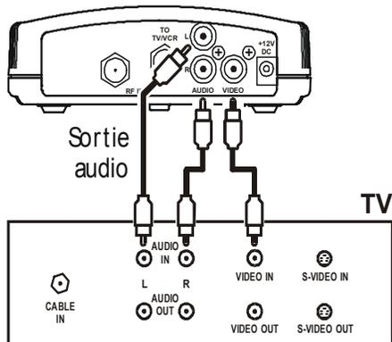
Dans ces illustrations, les connecteurs de bande de base des composants du système de divertissement portent la marque R pour le canal audio droit, L pour le canal audio gauche et V ou VIDEO pour la vidéo.
